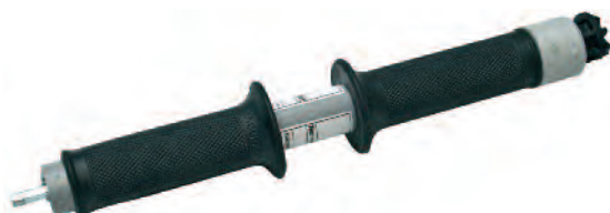
Erdungsgriff VI mit Doppelfunktion Zum Einsetzen der Erdungspatronen in NH- Sicherungsunterteile Zum Anschlieen der E+K-Vorrichtungen VI an Erdungspatronen, Griffnge 270mm
